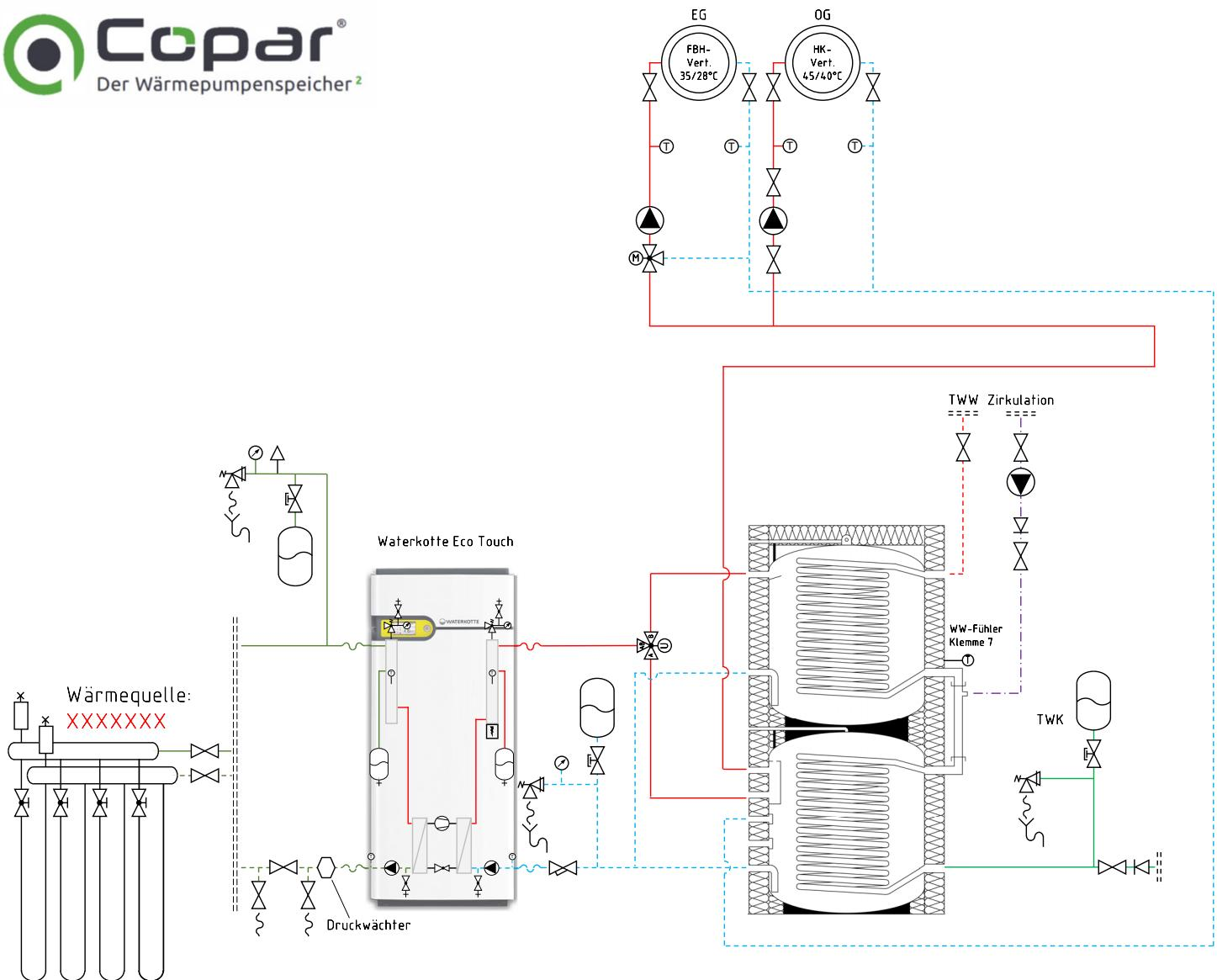
Entlüfter: bei Anlagen mit R290 dürfen im Gebäude keine automatischen Entlüfter verbaut werden!
