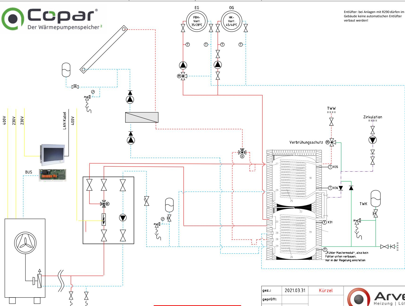
Entlüfter: bei Anlagen mit R290 dürfen im Gebäude keine automatischen Entlüfter verbaut werden!
